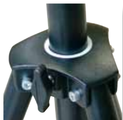
Chariot en aluminium coulé avec molette de serrage sur cale polyamide et bague téflon pour un coulisement parfait. Double verrouillage avec goupille de sécurité
