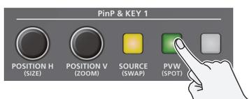
L'écran incrusté apparaît dans la section PVW de la vue multiple, vous permettant de vérifier l'emplacement et la taille de l'écran incrusté.
