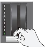
La vidéo sur le bus PGM/A est la sortie finale. Lorsque le fader vidéo est enfoncé à fond, seul l'indicateur de transition le plus haut ou le plus bas s'allume.
