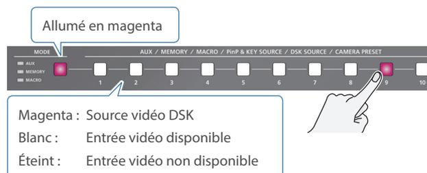
\* Lors de la sélection d'une vidéo non affectée aux INPUT 1 à 10, réglez-la à partir du bouton [MENU] ➔ « DSK » ➔ « DSK 1 » ➔ « DSK SOURCE ».
