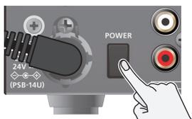
3. Mettez les appareils sous tension dans l'ordre suivant : appareils source → appareils de sortie.
